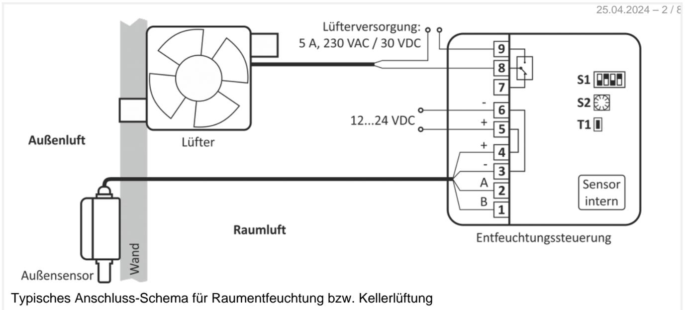
Mit dem Mikro-Taster *T1* kann eine Funktionsprobe der Lüftung durchgeführt werden. Bei Betätigung des Tasters wird das Relais geschlossen und der Lüfter beginnt sich zu drehen.
